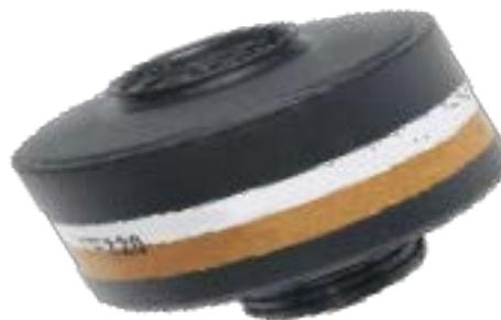
Ce type de filtres est à utiliser de préférence sur des APR avec les filtres au niveau de la ceinture pour des raisons de confort. Attention : certains APR ne sont pas conçus pour être utilisés avec des cartouches combinées même si celles-ci se montent dessus. Pour certains APR à ventilation assistée, le débit ou l'autonomie peuvent être insuffisants lorsque des filtres combinés sont utilisés.
