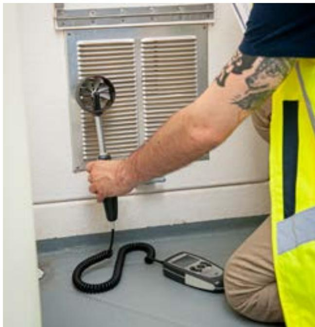
Mesure des vitesses sur une entrée d'air dans une UMD
