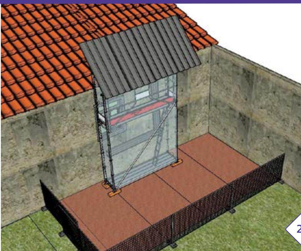
Sur des sols trop hétérogènes en périphérie de façades de bâtiments ou au sein de bâtiments industriels en friche contenant de nombreux cailloux ou des éléments saillants, le recours à la mise en place de plaques métalliques ou en bois par exemple, permettra d'assurer la protection physique des films au sol et du cuvelage.
